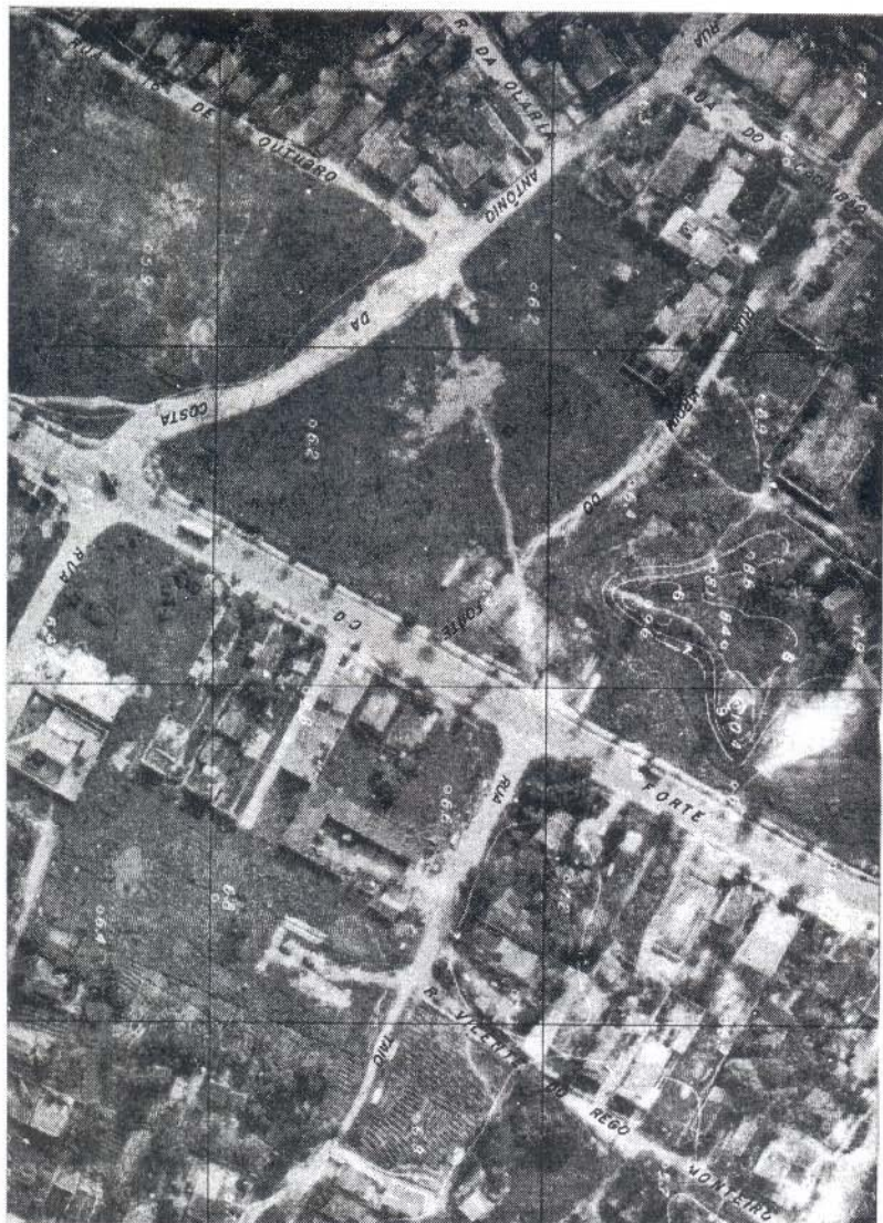
Ortofoto da área em torno do Forte (novo) do Bom Jesus. Observe-se as curvas de nível do local, que mostram que os desníveis máximos encontrados na área, não permitiram admitir-se a existência de colinas.
