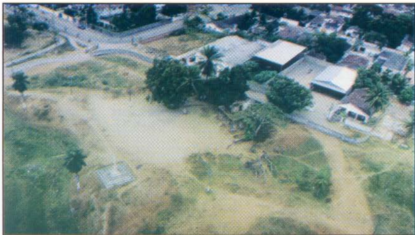
Vista aérea das ruínas do Arraial Novo do Bom Jesus. Observa-se o seu traçado a partir dos vestígios dos bastiões, das cortinas e da praça de armas. O traçado do fosso pode ser ressaltado pela vegetação mais verde em decorrência de sua cota permitir uma maior retenção da umidade. Tomada realizada com o apoio de um helicóptero "Pantera" do Exército brasileiro. Foto Doris Walmsley
